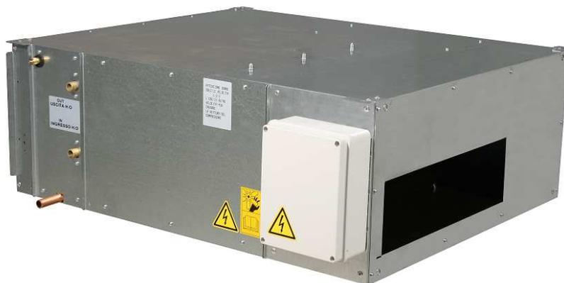
Los modelos **DRC Y DRCC**, son equipos diseñados para falso techo o conductos. Están provistos de una batería de pre y post para aumentar el rendimiento y controlar la temperatura del aire de salida.
